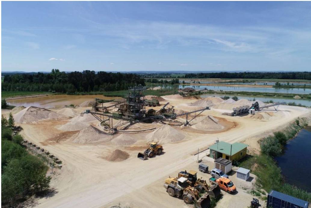
Foto 1: Abbau Flugsand durch die Firma Anton Eireiner GmbH in Laub Foto: Herr Philipp Baumann, Firma Anton Eireiner GmbH
